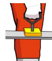
Rys. 5. Przenoszenie nieporęcznych przedmiotów za pomocą chwytaka z głowicą z tworzywa sztucznego
